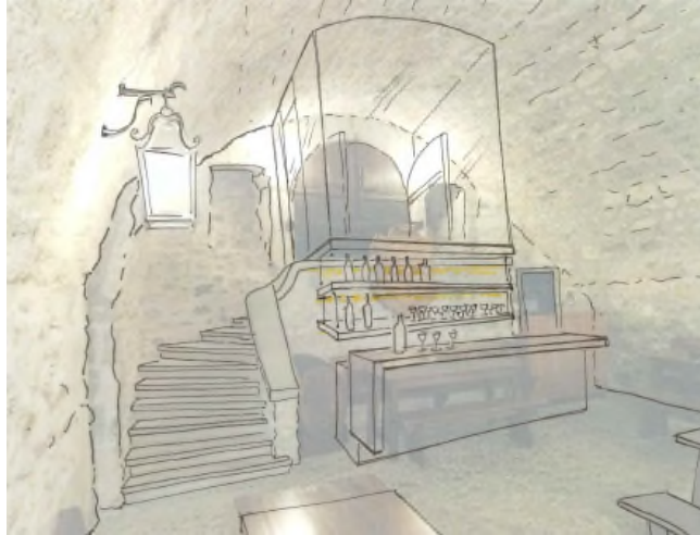
Création d'un sas, faisant office de sortie de secours et installation d'un comptoir-bar
