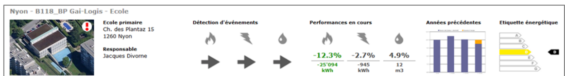
Exemple de suivi à court (hebdomadaire), moyen (annuel) et long (pluriannuel) terme des consommations d'un bâtiment
