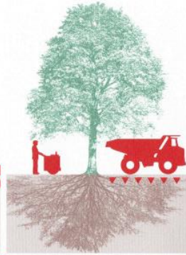
Compactage du sol
