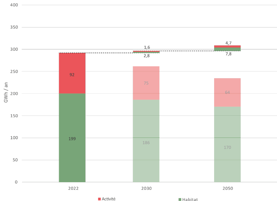
Fig. 18 : Évolution des consommations d'énergie en prenant en compte les nouvelles surfaces de logement et d'activité, en regard des objectifs NPE.
