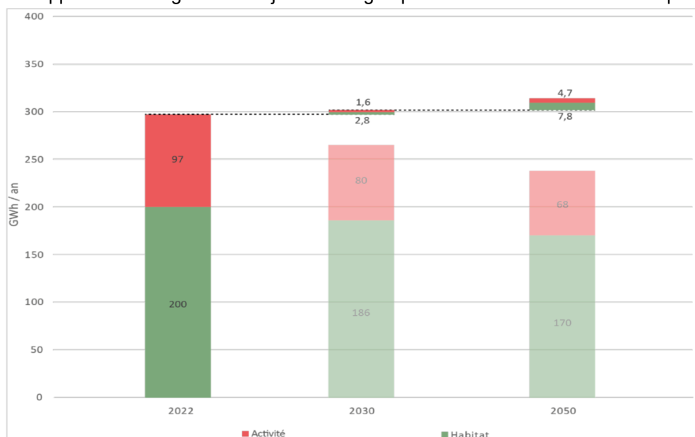
Figure 10: évolution de la consommation énergétique du parc bâti prévu selon le développement urbain de Nyon (Urbaplan, 2023)
